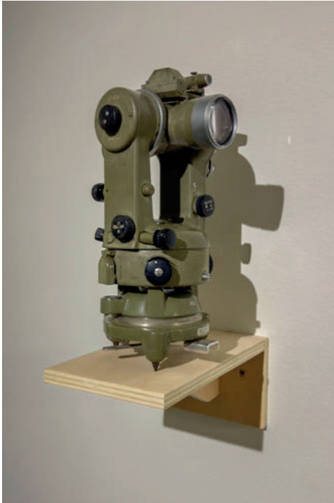
Pedro Vaz Teodolito , prod. 1960 Instrumento de precisão óptica para navegação, Teodolito Kern modelo K1-RA No121169 Optical precision instrument for navigation, Kern Theodolite model K1-RA No121169 31 x 13 x 13 cm © Pedro Vaz
